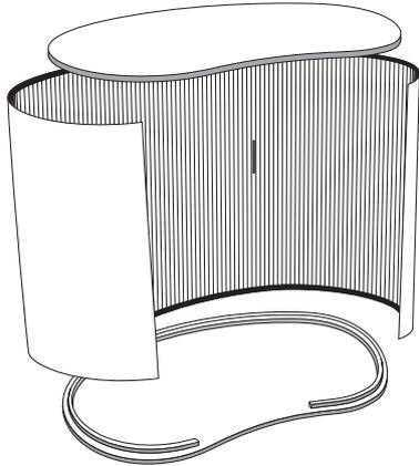
Verbinden Sie die Bodenplatte, die Lamellenwand und die Deckplatte mithilfe der Klettverschlüsse.
