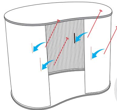
Stecken Sie nun die Metallstäbe mit den Ösen in die Schlitze an der Innenseite der Lamellenwand.
