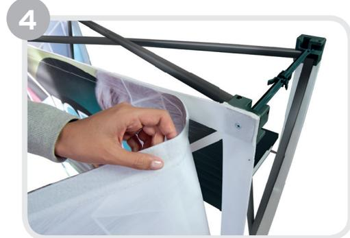
4 Nehmen Sie nun Ihre bedruckte Textilbespannung und montieren Sie diese entlang des Klettverschlusses.
